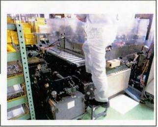
タラップを取り付けて安全に登れるように改善。 作業台上面に、滑り止めテープを貼り付け。
