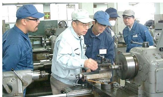
＜研いだバイトの切れ味を旋盤で試す様子＞
